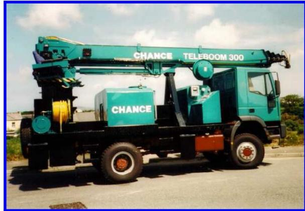
Toutes les flèches assurent un lavage sans danger éprouvé sur des lignes allant jusqu'à 500 kV avec des pressions maximales de buse de 550 psi grâce à une buse télécommandée entièrement articulée.
