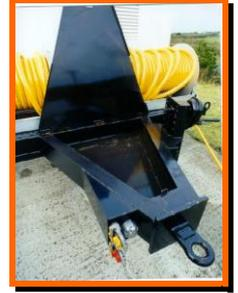
Enganche con caja para herramientas y accesorios con cerrojo, empalmes neumáticos de conexión rápida y ojal de remolque de norma
