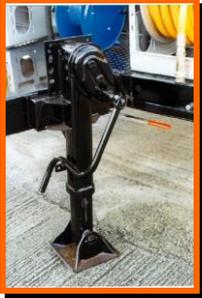
Gato regulable de servicio pesado de norma permitiendo el posicionamiento sin necesidad de un vehiculo remolcador.
