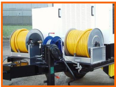
2 carretes con de 50 m de manguera aislada de 1" de servicio pesado con rebobinado manual de norma (rebobinado eléctrico - opcional)
