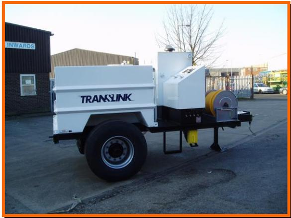
**LOS LAVADORES DE AISLADORES DE LÍNEAS ENERGIZADAS DE LA SERIE SOBRE REMOLQUE CHANCE esta montada sobre un eje de servicio pesado para terreno accidentado y cuenta con llantas para servicio fuera de carretera de norma.**
