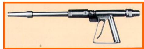
Pistolas de lavado alta presión en acero inoxidable con gatillo de interrupción automática, empalmes de conexión rápida, enderezador de flujo y nodriza de 1/4 de pulgada. Pistolas con nodrizas de 5/16 de pulgada disponibles para condiciones de vientos fuertes. Medidores de presión y de manguera flexible de 3 m - opcionales. Todas las piezas son intercambiables.
