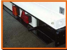
Conjunto de iluminación para carretera con luces de freno; intermitentes y luces de emergencia de norma.
