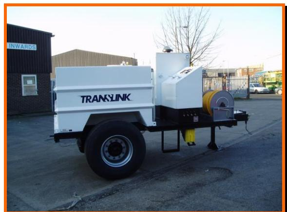
**LES LAVEURS D'ISOLATEURS DE LIGNE SOUS TENSION MONTÉS SUR REMORQUE CHANCE** sont équipés d'un essieu lourd robuste pour terrain accidenté avec pneus sable en série.
