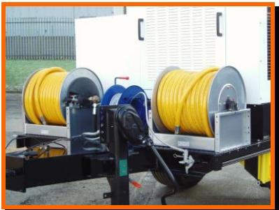
2 dévidoirs manuels avec 50 m de tuyau de lavage isolé robuste d'1" sont montés en série (dévidoir électrique en option)
