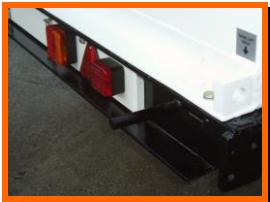
Système d'éclairage de route standard avec freins, clignotants et feux de détresse.
