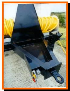
Compartiment à outils verrouillable standard pour rangement des pistolets de lavage avec raccords d'air rapides et boucle de remorquage.
