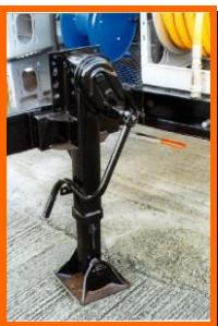
Cric réglable robuste standard permettant de stationner facilement sans le véhicule de remorquage.
