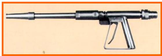
Pistolets de lavage haute pression en acier inoxydable avec contrôle de gâchette du type 'homme-mort', raccords rapides, stabilisateur de débit et buse d'1/4". Pour les conditions de grand vent, des pistolets à buses de 5/16" sont disponibles. Un manomètre et 3 m de tuyau volant sont en option. Toutes les pièces sont interchangeables.
