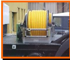
Dévidoir électrique de tuyau (50 m) en option avec raccords rapides et guide-tuyau.
